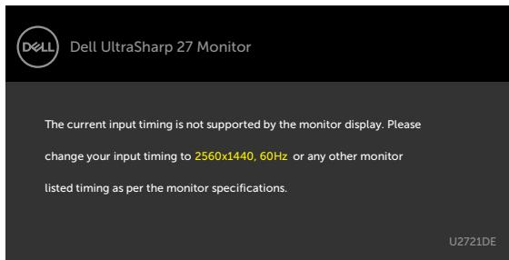
Ovo znači da monitor ne može da se sinhronizuje sa signalom koji prima od kompjutera. Pogledajte [Monitor Specifications \(Specifikacije monitora\)](#) za opsege horizontalne i vertikalne frekvencije koje ovaj monitor konstantuje. Preporučeni režim je 1920 x 1080 (U2421HE)/2560 x 1440 (U2721DE).
