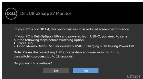
Ako je **USB-C Charging (Punjjenje preko USB-C)** podešeno na **On During Power Off (Uključeno tokom isključivanja)**, kada izaberete stavku prikaza na ekranu za **USB-C Prioritization (Određivanje prioriteta za USB-C)** na **High Resolution (Visoka rezolucija)** ili **High Data Speed (Visoka brzina prenosa podataka)** u funkciji Display (Prikaz) pojaviće se sledeća poruka:
