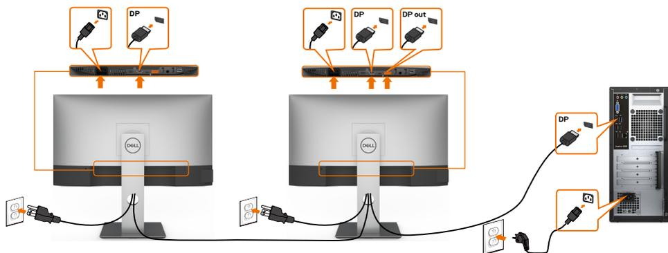
**ПРИМЕЧАНИЕ.** Монитор поддерживает функцию DP MST. Для использования этой функции видеокарта компьютера должна соответствовать спецификации DP1.2 и поддерживать режим MST.
