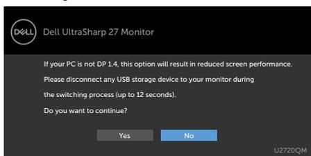
Selezionando la voce del menu OSD **Alta velocità dati** nella funzione Display, viene visualizzato il seguente messaggio:
