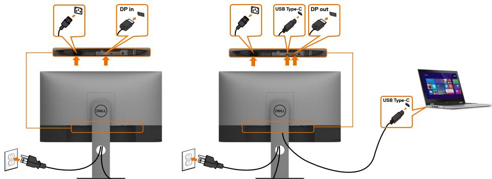
**NOT:** MST aracılığıyla desteklenen en fazla U2719DC sayısı USB-C kaynağının bant genişliğine bağlıdır. Lütfen "[Ürüne özel sorunlar – USB-C MST kullanılırken görüntü yok](#)" kısmına başvurun.
