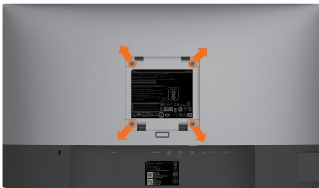
**NOT:** Monitörü, duvara montaj setine bağlamak için M4 x 10 mm vidaları kullanın.
