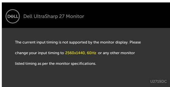
Ovo znači da monitor ne može da se sinhronizuje sa signalom koji prima od kompjutera. Pogledajte [Monitor Specifications \(Specifikacije monitora\)](#) za opsege horizontalne i vertikalne frekvencije koje ovaj monitor konstantuje. Preporučeni režim je 1920 x 1080 (U2419HC)/2560 x 1440 (U2719DC).
