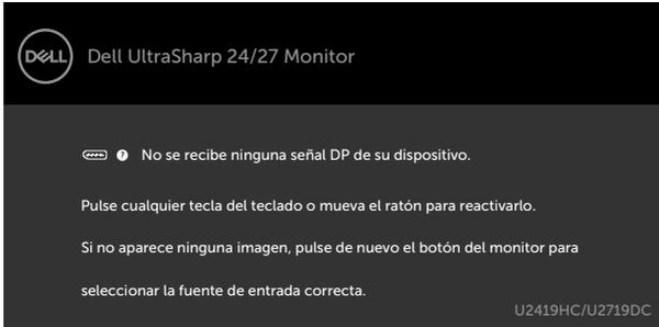
Si se selecciona la entrada DP o USB de tipo C y el cable correspondiente no está conectado, aparece un cuadro de diálogo flotante como el que se muestra abajo.
