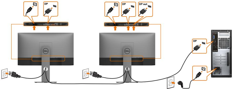
**NOTA:** El dispositivo admite la función DP MST. Para utilizar esta función, la tarjeta gráfica de su equipo debe contar con la certificación para utilizar DP1.2 con la opción MST.
