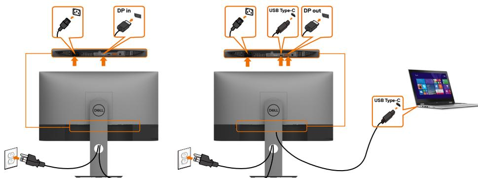
**NOTA:** El número máximo de U2719DC admitidos a través de MST depende del ancho de banda de la fuente USB-C. Consulte el apartado "[Problemas específicos del producto – No se muestra la imagen cuando se utiliza MST a través de USB-C](#)".
