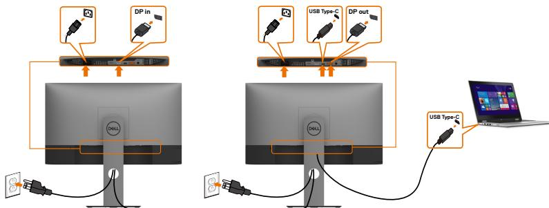
**ЗАБЕЛЕЖКА:** Максималният брой поддържани U2719DC чрез MST зависи от пропускателната способност на USB-C източника. Вижте [“проблеми, специфични за продукта – няма образ при използване на USB-C MST”](#).
