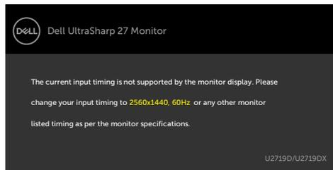
Това означава, че мониторът не може да се синхронизира със сигнала, който получава от компютъра. Вижте [Технически характеристики на монитора](#) относно диапазона на хоризонтална и вертикална честота, които са адресирани за този монитор. Препоръчителният режим е 1920 x 1080 (U2419H/U2419HX)/2560 x 1440 (U2719D/U2719DX).
