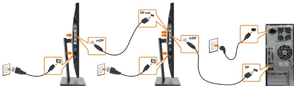
**ПРИМЕЧАНИЕ.** Монитор поддерживает функцию DP MST. Для использования этой функции видеокarta компьютера должна соответствовать спецификации DP1.2 и поддерживать режим MST.
