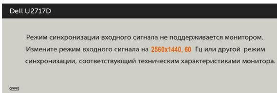
Это означает, что монитор не может произвести синхронизацию с получаемым от компьютера сигналом. Информацию о диапазонах частоты строк и кадров, применимых к данному монитору, см. в разделе [Технические характеристики монитора](#). Рекомендуется разрешение 2560 x 1440.
