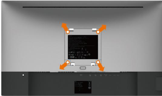
**CATATAN:** Gunakan sekrup M4 x 10 mm untuk memasang monitor ke kit dudukan dinding.
