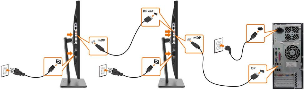
**NOTA:** El dispositivo admite la función DP MST. Para utilizar esta función, la tarjeta gráfica de su equipo debe contar con la certificación para utilizar DP1.2 con la opción MST.
