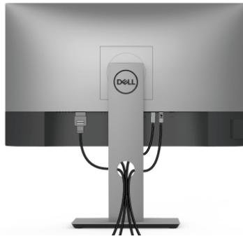
Después de conectar todos los cables necesarios al monitor y al PC, (consulte [Conexión de su monitor](#) para conectar los cables), utilice la ranura de sujeción de cables para organizarlos correctamente tal y como se muestra arriba.
