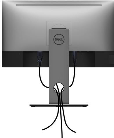
Setelah memasang semua kabel yang diperlukan ke monitor dan komputer Anda, (lihat [Menghubungkan Monitor Anda](#) untuk pemasangan kabel) aturlah semua kabel seperti yang ditunjukkan di atas.
