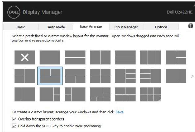
Jika menggunakan beberapa monitor dalam suatu susunan atau matriks, tata letak **Easy Arrange (Atur Mudah)** dapat diterapkan pada semua monitor sebagai satu desktop. Pilih "**Span multiple monitors**" (**Bentangkan beberapa monitor**) untuk mengaktifkan fitur ini. Anda harus meluruskan monitor benar untuk membuatnya efektif.
