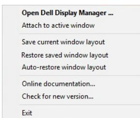
За да се върнете на предпочитано оформление, първо **"Save current window layout" (Запис на оформление на текущия прозорец)** и после **"Restore saved window layout" (Възстановяване на оформление на записан прозорец)**.
