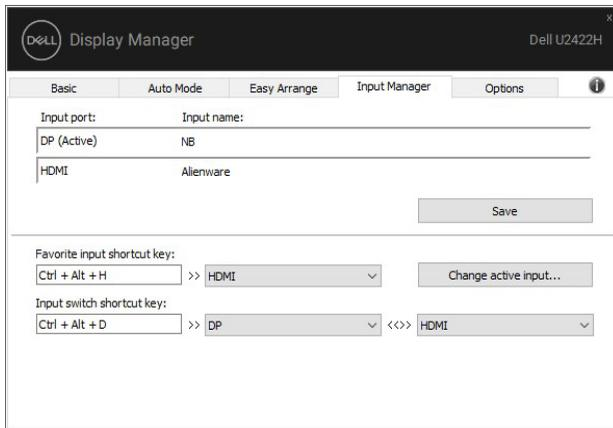
Можете да използвате падащото меню за превключване към произволен източник на входен сигнал.
