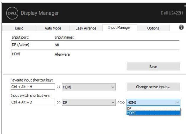
**ЗАБЕЛЕЖКА:** DDM общува с Вашия монитор дори и когато мониторът показва видео от друг компютър. Можете да инсталирате DDM на компютър, който използвате често, и да управлявате превключването на входен сигнал от него. Можете да инсталирате също DDM на други компютри, свързани към монитора.
