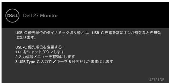
**USB-C Charging（USB-C充電）がOff During Power Off（電源オフ時にオフ）**に設定されており、**USB-C Prioritization（USB-優先順位）がHigh Data Speed（高データ速度）**に設定されている場合：
