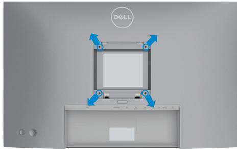
**CATATAN:** Gunakan sekrup M4 x 10 mm untuk menyambungkan monitor dengan kit pemasangan di dinding.
