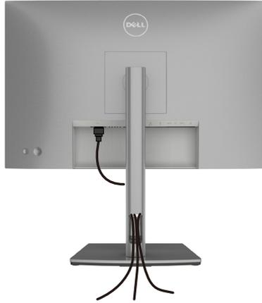
Setelah memasang semua kabel yang diperlukan ke monitor dan komputer, (lihat [Menyambungkan Monitor](#) untuk pemasangan kabel), rapikan semua kabel sebagaimana ditunjukkan di atas.
