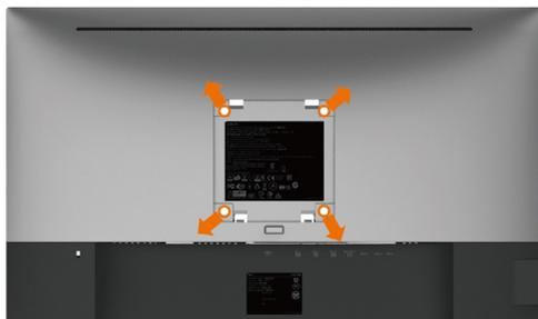
**注：** 使用M4 x 10 mm螺丝将显示器连接到壁挂套件。
