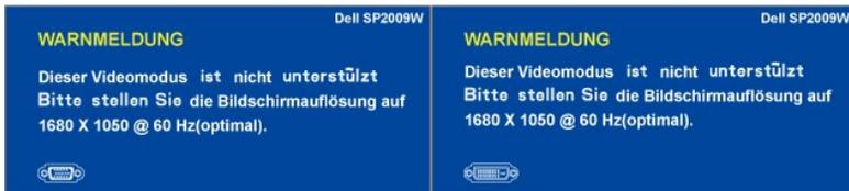
Das bedeutet, dass der Monitor sich nicht mit dem Signal synchronisieren kann, das er vom Computer empfängt. Das Signal ist zu hoch oder zu niedrig für den Monitor. Sehen Sie bitte in [Technische Daten](#) für die horizontalen und vertikalen Frequenzbereiche, die von diesem Monitor unterstützt werden, nach. Der empfohlene Modus ist 1680 X 1050 mit 60Hz.
