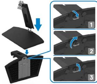
2. 將可調支架的托架與顯示器背面的凹槽對齊。
