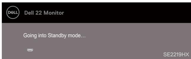
Se il cavo VGA o HDMI non è collegato, viene visualizzata una finestra di dialogo mobile come mostrato di seguito. Il monitor entrerà in Modalità Standby dopo 4 minuti se lasciato in questo stato.
