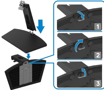
2. Alinee el elevador del soporte con las ranuras en la parte posterior del monitor.
