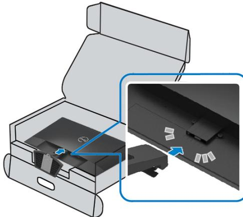
3. Deslice el ensamblaje del soporte hasta que encaje en su lugar.
