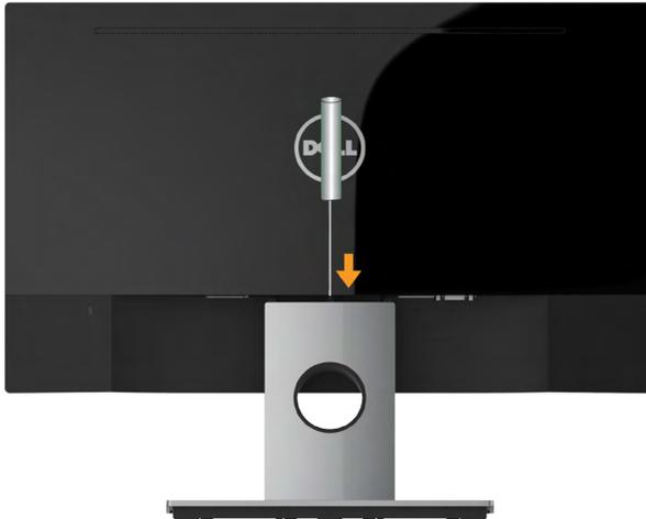
將顯示器面板放在軟布或軟墊上後，完成下列步驟將底座拆除
