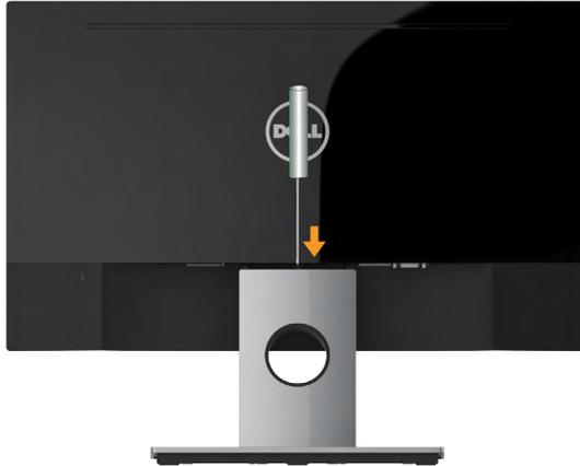
1. Utilice un destornillador largo para empujar el seguro de liberación situado en un orificio justo encima de la base.
