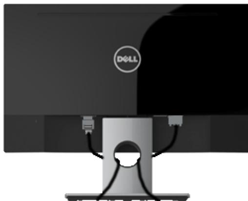
Una vez conectados todos los cables necesarios al monitor y al PC (consulte la sección Conectar el monitor para obtener más información sobre la conexión de los cables), orgánizelos como muestra la ilustración anterior.
