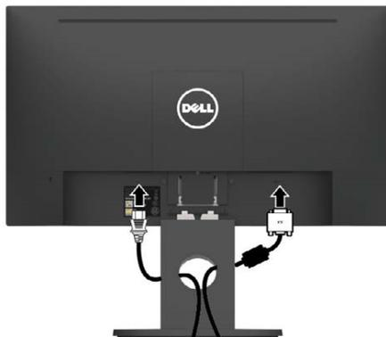
必要なすべてのケーブルをモニターとコンピューターに接続した後(ケーブルの取り付けについては、モニターの接続を参照してください)、上の図のようにすべてのケーブルを整理します。
