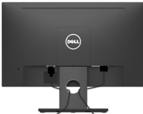
Depois de conectar todos os cabos necessários no seu monitor e no computador, (Veja Conectando Seu Monitor por anexamentos de cabo), organize todos os cabos como mostrado acima.
