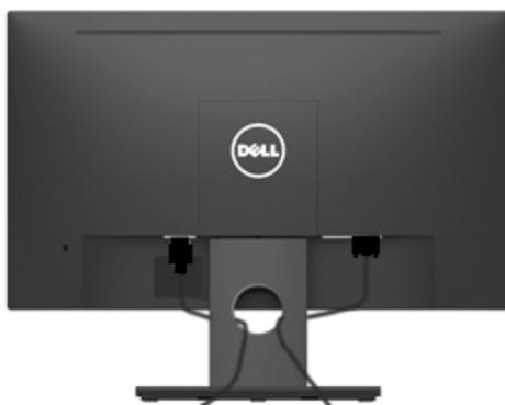
Una volta collegati tutti i cavi necessari al monitor e al computer (consultare [Collegamento del monitor](#) per il collegamento del cavo), utilizzare la fessura di gestione dei cavi per organizzare tutti i cavi come illustrato in precedenza.
