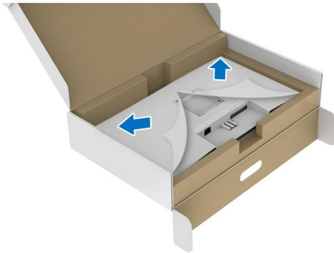
7. Allineare e inserire la staffa del gruppo del supporto nelle scanalature sul retro del display fino a bloccarle in posizione.
