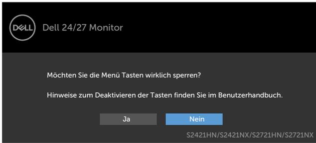
3. Wählen Sie Ja, um die Tasten zu sperren. Sobald die Tasten gesperrt, wird beim Drücken einer beliebigen Taste das Sperrsymbol angezeigt
