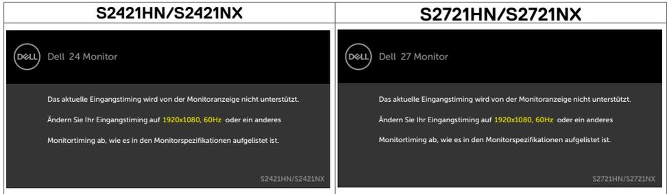
Das bedeutet, dass sich der Monitor mit dem vom Computer empfangenen Signal nicht synchronisieren kann. Siehe [Auflösungsspezifikationen](#) für die horizontalen und vertikalen Frequenzbereiche, die für diesen Monitor adressierbar sind. Empfohlener Modus ist 1920 x 1080.
