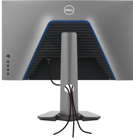
Dopo avere collegato tutti i cavi necessari al monitor ed al computer (fare riferimento alla sezione [Collegamento del monitor](#) per il collegamento dei cavi), organizzare tutti i cavi come mostrato sopra.
