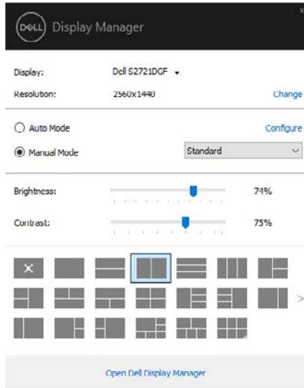
Kotak dialog **Quick Settings (Pengaturan Cepat)** juga memberikan akses ke antarmuka pengguna lanjutan Dell Display Manager untuk menyesuaikan fungsi dasar, mengkonfigurasi mode otomatis, dan mengakses fitur lainnya.
