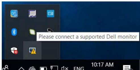
Kliknite ikonu, DDM će prikazati detaljniju poruku o pogrešci.
