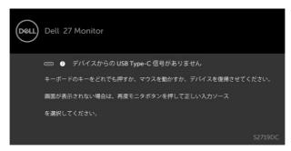
Smart HDR がオンのとき、プリセットモードを変更しようとすると、次のメッセージが表示されます。
