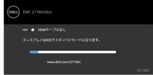
**4** このボックスは、ビデオケーブルが切断または破損した場合にも、通常のシステム操作時に表示されます。
