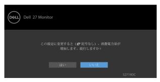
輝度レベルをデフォルトレベルの75%以上に調整すると、次のメッセージが表示されます:
