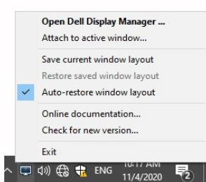
Če izberete »Auto-restore window layout« (**Samodejno obnovi postavitev oken**), DDM sledi položajem oken aplikacij in si jih zapomni. DDM samodejno postavi okna aplikacij na njihove izvirne položaje, ko računalnik znova povežete z monitorji.
