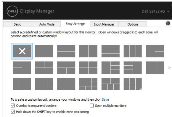
Če uporabljate več monitorjev v skupini ali matriki, lahko postavitev **Easy Arrange (Preprosta razporeditev)** uveljavite za vse monitorje kot za eno namizje. To funkcijo omogočite tako, da izberete »**Span multiple monitors**« (**Vključi več monitorjev**). Za učinkovito delovanje morate monitorje pravilno poravnati.
