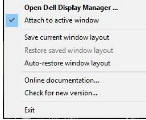
Araç çubuğundaki simgeye sağ tıkladığınızda, DDM'nin bir hızlı menüsü belirir, kolaylıkla ayar yapabilmemiz için **Auto Mode (Otomatik Mod)** ve **Easy Arrange (Kolay Düzenleme)** altındaki seçenekleri görüntüler.
