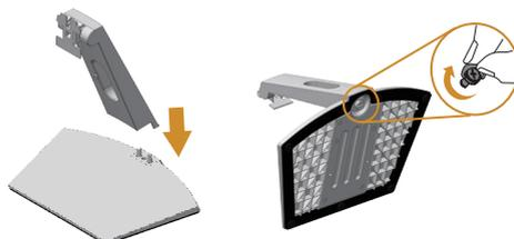
3. Faites rentrer les deux onglets de la partie supérieure du socle dans les fentes à l'arrière du moniteur. Appuyez sur le socle jusqu'à ce qu'il s'enclenche en place.
