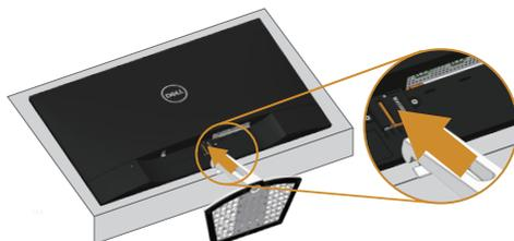
4. Insérer le socle jusqu'à ce qu'il s'enclenche verrouillé.
