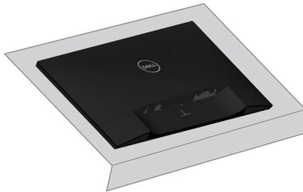
2. Encaixe a elevação do suporte e base do suporte e então parafuse a base do suporte.
