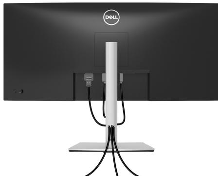
在显示器和计算机连接所有必要的电缆之后，（关于电缆连接请参见[连接显示器](#)），有条理地设置上述所有电缆。
