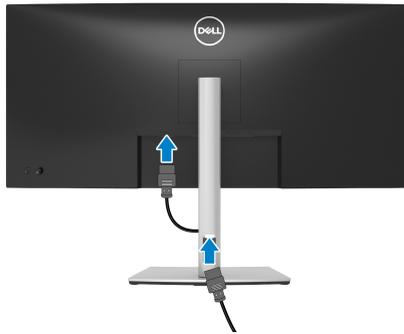
3. 将 DisplayPort、HDMI 或 USB Type-C 电缆连接到显示器和计算机。
