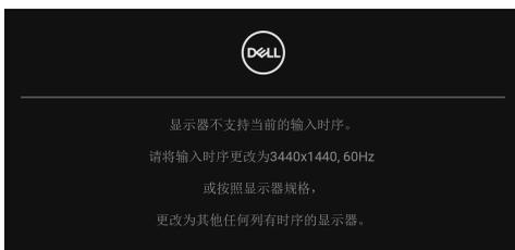
这表示显示器无法与从计算机接收的信号同步。关于本显示器支持的水平和垂直频率，请参见[显示器规格](#)。建议模式为 3440 x 1440。
