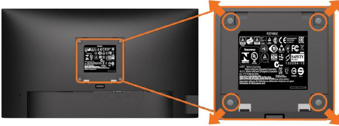
**注：** 使用M4 x 10 mm螺丝将显示器连接到壁挂套件。
