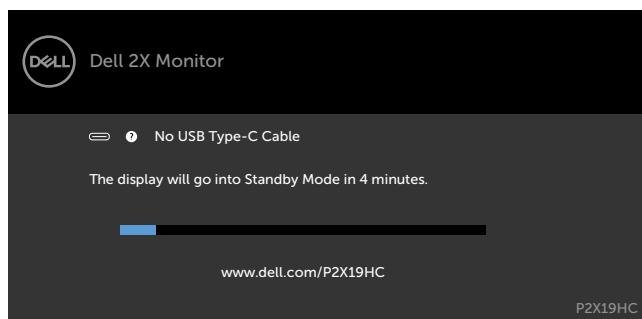
Khi màn hình đang chiếu video từ DP/HDMI và người dùng kết nối cáp USB loại C với máy tính bảng/điện thoại có hỗ trợ chế độ DP Alternate, nếu mục **Lựa chọn tự động USB loại C** được chọn là Nhắc khi có nhiều nguồn, thông báo sau sẽ xuất hiện:
