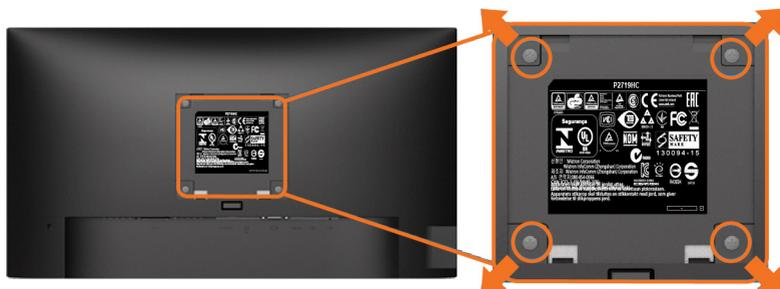
**注意:** 壁取り付けキットにモニターを接続するには、M4 x 10 mmネジを使用します。
