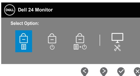
Per accedere al menu di sblocco: Tenere premuto il tasto Exit (Esci) (tasto 4) per 4 secondi per visualizzare il menu di sblocco (con i tasti menu e di alimentazione bloccati). Appare un menu di sblocco visualizzato nell'angolo in basso a destra del display.
