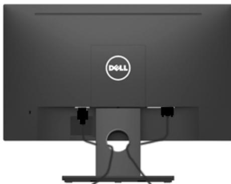
Una volta collegati tutti i cavi necessari al monitor e al computer (consultare [Collegamento del monitor](#) per il collegamento del cavo), utilizzare la fessura di gestione dei cavi per organizzare tutti i cavi come illustrato in precedenza.
