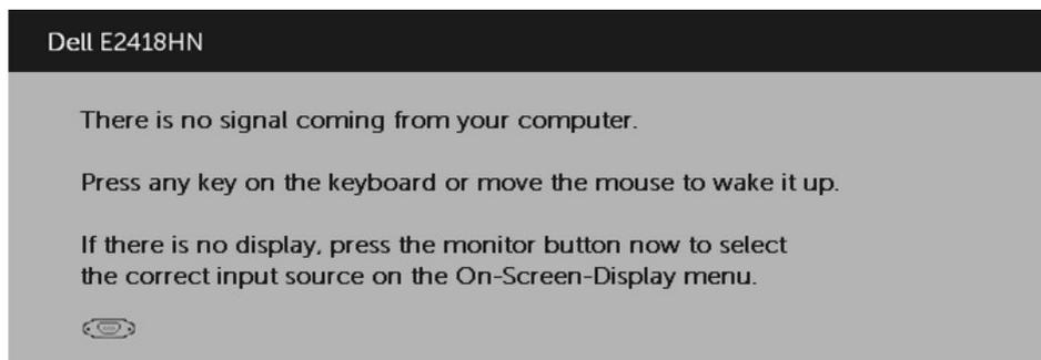
Se il cavo VGA o HDMI non è collegato, viene visualizzata una finestra di dialogo mobile come mostrato di seguito. Se lasciato in questo stato, il monitor accederà alla modalità **Power Save (Risparmio energetico) dopo 4 minuti**.
