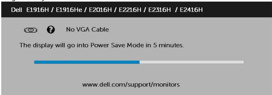
4. Kotak ini akan muncul selama pengoperasian sistem normal, jika sambungan kabel video terlepas atau rusak. Monitor akan beralih ke **Mode Hemat Daya setelah 5 menit** dibiarkan dalam kondisi ini.
