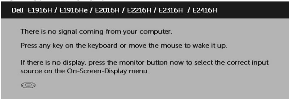
Jika kabel VGA atau DP tidak tersambung, maka kotak dialog mengambang seperti ditunjukkan di bawah ini akan muncul di layar. Monitor akan beralih ke **Mode Hemat Daya setelah 5 menit** dibiarkan dalam kondisi ini.
