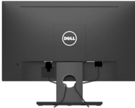
Setelah memasang semua kabel yang diperlukan ke monitor dan komputer, (lihat [Menyambungkan Monitor](#) untuk pemasangan kabel,) gunakan slot pengaturan kabel untuk merapikan semua kabel seperti ditunjukkan di atas.
