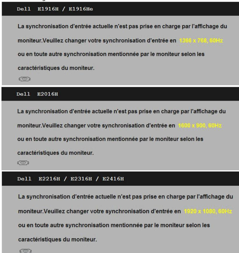
Cela signifie que l'écran ne peut pas se synchroniser avec le signal reçu depuis l'ordinateur. Voir **Spécifications du moniteur** pour vérifier les limites de la fréquence horizontale et verticale pour ce moniteur. Le mode recommandé est 1366 x 768 (pour le E1916H / E1916He) ou 1600 x 900 ( pour le E2016H) ou 1920 x 1080 (pour le E2216H / E2316H / E2316Hr / E2416H / E2416HM).
