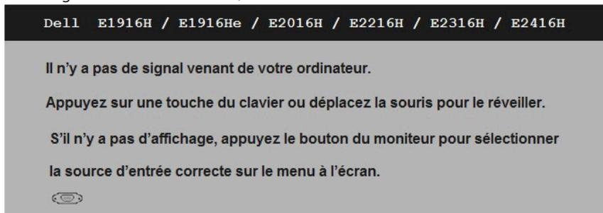
Si le câble VGA ou DP n'est pas branché, une boîte de dialogue flottante s'affichera, indiquée ci-dessous. Le moniteur entrera en **Mode d'économie d'énergie dans 5 minutes** s'il reste inutilisé.
