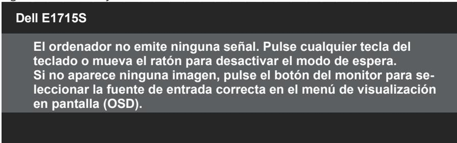
Si el cable VGA o DP no están conectados, aparecerá un cuadro de diálogo flotante, tal y como se muestra a continuación. El monitor entrará en el **modo de Ahorro de energía después de 5 minutos** si permanece en este estado.
