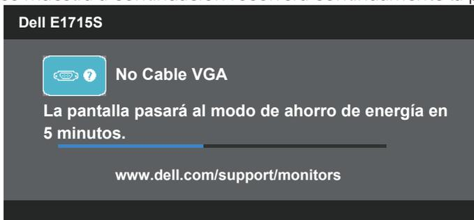
4. Este cuadro también aparece durante el funcionamiento normal del sistema en el caso de que el cable de vídeo se desconecte o sufra algún tipo de daño. El monitor entrará en el **modo de Ahorro de energía después de 5 minutos** si permanece en este estado.
