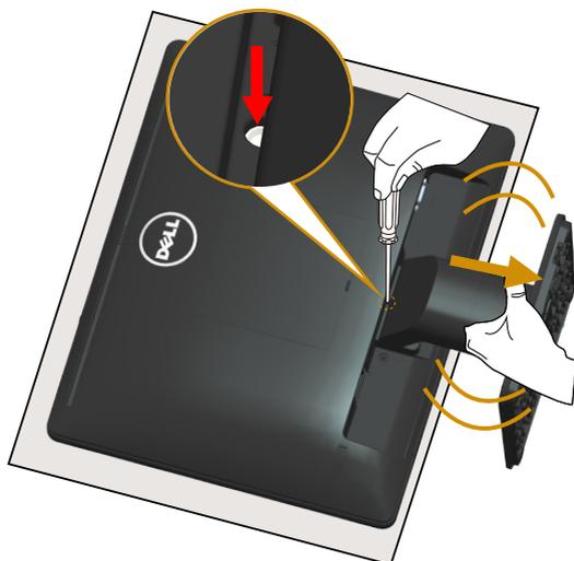
Después de colocar el panel del monitor sobre un paño suave o cojín, siga los pasos que se indican a continuación para desmontar la base:
