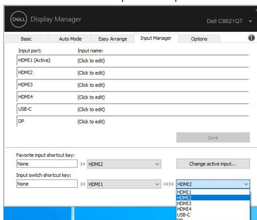
**OPOMBA:** Aplikacija DDM komunicira z monitorjem, tudi ko je na njem prikazan video iz drugega računalnika. Aplikacijo DDM lahko namestite v računalnik, ki ga pogosto uporabljate, in upravljate preklapljanje med vhodi iz njega. Aplikacijo DDM lahko namestite tudi v druge računalnike, priključene na monitor.
