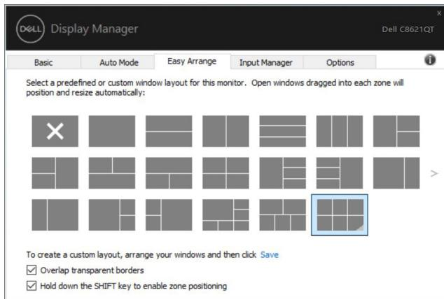
Če uporabljate več monitorjev v nizu ali matrici, lahko postavitev, izbrano z možnostjo **Easy Arrange (Preprosta razporeditev)**, uporabite za vse monitorje kot eno namizje. Če želite omogočiti to funkcijo, izberite »**Span multiple monitors**« (**Obsegaj več monitorjev**). Da bo funkcija učinkovala, morate monitorje ustrezno poravnati.
