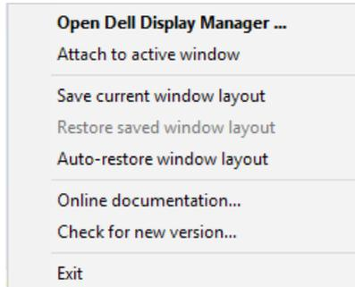
Če izberete možnost »**Auto-restore window layout**« (**Samodejno obnovi postavitev oken**), aplikacija DDM sledi postavitvam aplikacijskih oken in si jih zapomni. Pri ponovni priključitvi računalnika na monitor(je) aplikacija DDM samodejno razporedi aplikacijska okna v prvotne postavitve.
