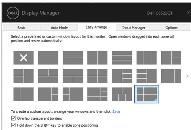
Če uporabljate več monitorjev v nizu ali matrici, lahko postavitev, izbrano z možnostjo **Easy Arrange (Preprosta razporeditev)**, uporabite za vse monitorje kot eno namizje. Če želite omogočiti to funkcijo, izberite »**Span multiple monitors**« (**Obsega več monitorjev**). Da bo funkcija učinkovala, morate monitorje ustrezno poravnati.
