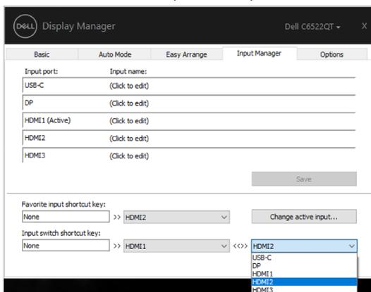
**OPOMBA:** Aplikacija DDM komunicira z monitorjem, tudi ko je na njem prikazan video iz drugega računalnika. Aplikacijo DDM lahko namestite v računalnik, ki ga pogosto uporabljate, in upravljate preklapljanje med vhodi iz njega. Aplikacijo DDM lahko namestite tudi v druge računalnike, priključene na monitor.
