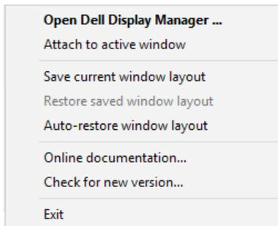
Ако изберете “**Auto-restore window layout**” (**Автоматично възстановяване на оформлението на прозорците**), позициите на прозорците на Вашите приложенията се проследяват и запомнят от DDM. DDM автоматично поставя прозорците на приложенията в техните първоначални позиции при повторно свързване на Вашия компютър с Вашия монитор(и).
